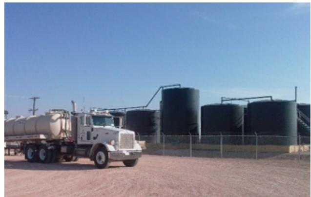
Figura 7: Descarregamento do caminhão na bateria do tanque para armazenamento e separação de água salgada/óleo
