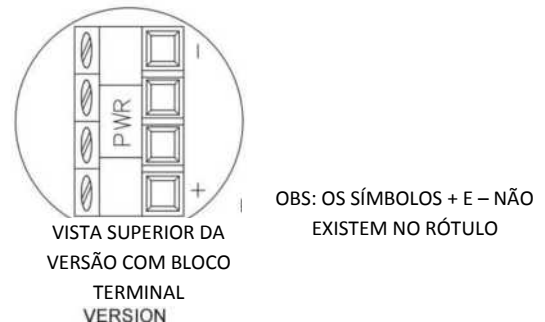
Figura 4 – Vista superior mostrando as conexões da saída dinâmica opcional em transmissores com chicotes
