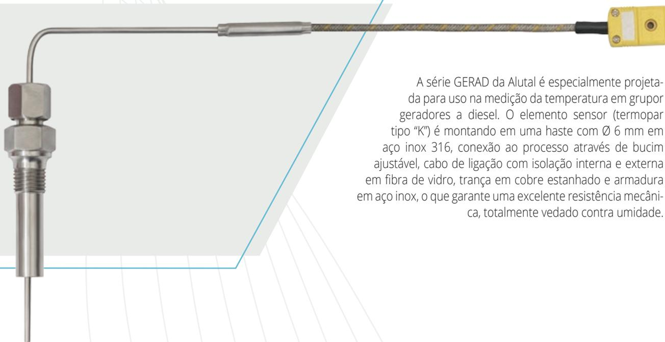
A série GERAD da Alutal é especialmente projetada para uso na medição da temperatura em grupos geradores a diesel. O elemento sensor (termopar tipo "K") é montado em uma haste com Ø 6 mm em aço inox 316, conexão ao processo através de buçim ajustável, cabo de ligação com isolamento interno e externo em fibra de vidro, trança em cobre estanhado e armadura em aço inox, o que garante uma excelente resistência mecânica, totalmente vedado contra umidade.
