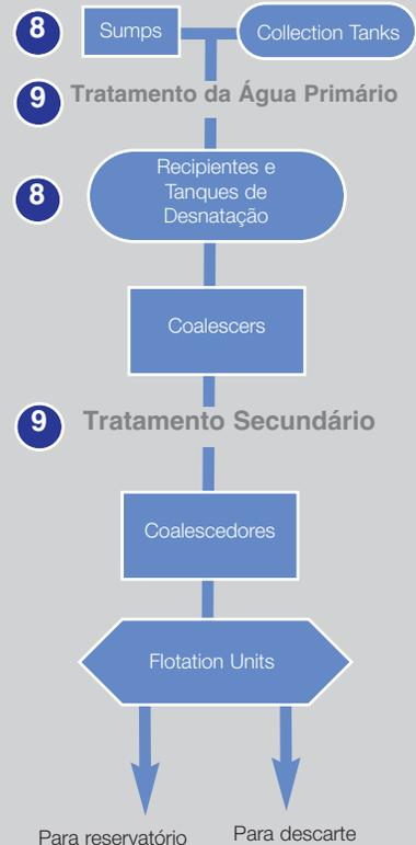
**NOTA:** A natureza real e o número de etapas no processo de criação de gás natural com qualidade de gasoduto depende da fonte e composição do fluxo de produção da cabeça de poço. Em alguns casos, várias das etapas mostradas no esquemático acima podem ser integradas em uma unidade ou operação, realizada em uma ordem diferente ou em locais alternativos, ou não necessária de forma alguma.
