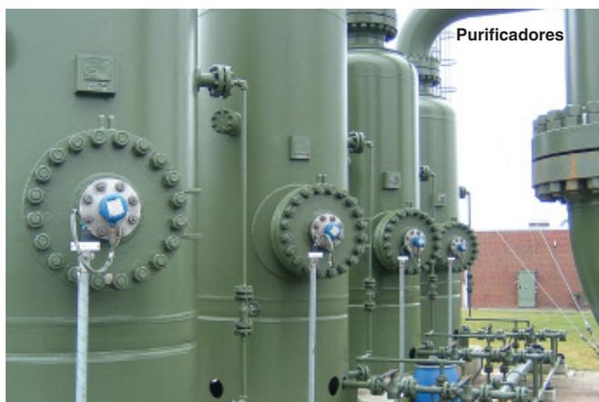
**Aplicação:** Gás natural pode viajar por milhares de quilômetros de encanamento. Compressores colocados em intervalos chave mantêm o gás natural se movendo uniformemente e com segurança. Uma estação típica de compressor consiste em um purificador de entrada para coletar líquidos e impurezas que tenham se formado no gasoduto. O purificador consiste em uma seção primária onde líquidos e sólidos são separados da corrente de gás e uma seção secundária onde se remove névoa de óleo.
