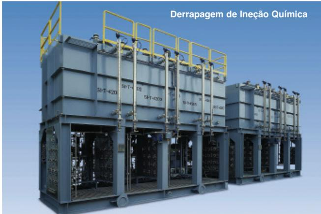
**Aplicação:** Agentes químicos empregados em processamento de gás natural incluem aditivos de fluidos de exploração, injeção de metanol para proteção de congelamento, injeção de glicol para inibição de hidratação, químicos de tratamento de água produzida, inibidores de espuma e corrosão, desemulsificadores, agentes químicos dessalinizadores e redutores de arraste. Químicos são frequentemente administrados por meio de derrapagem de injeção química.
