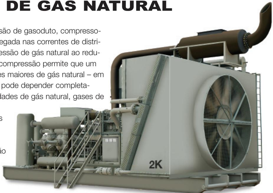
Acima, uma derrapagem de compressão de gás projetada para uso em campo. A configuração de um compressor é determinada por sua capacidade de compressão, tanto por ser do tipo de turbina ou retribuição, por sua fonte de energia, e pelos requisitos de atenuação ambiental ou sonora que podem ser exigidos.
