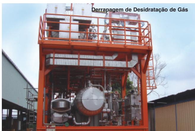
**Aplicação:** A desidratação de gás natural remove hidratos que podem crescer em cristais e linhas de plugue e retardam o fluxo de correntes de hidrocarbonetos gasosos. Ela também reduz corrosão, elimina espumas, e previne problemas de catalisador a jusante. As estações do compressor costumam ter algum tipo de separador líquido para desidratar o gás natural antes da compressão.
