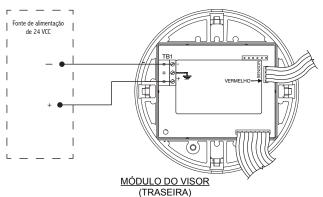
O One Series também pode ser alimentado por conexão direta a uma fonte de alimentação de 20-40 VCC. Todas as funções do dispositivo, incluindo SW1, SW2 e Saída do IAW™ são alimentadas. Nesta configuração, a saída analógica de 4-20 mA é desabilitada. Consulte o exemplo de Fiação abaixo para conhecer métodos adicionais de fiação.
