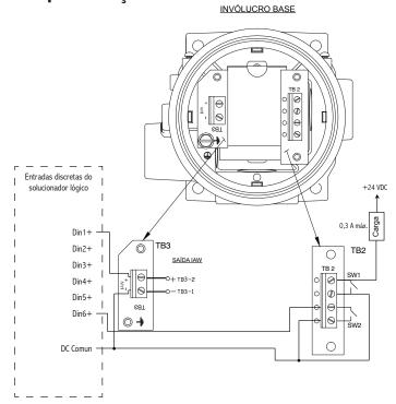
Este diagrama fornece um exemplo de esquema de fiação para comutadores SW1, SW2 e SAÍDA DO IAW™.
