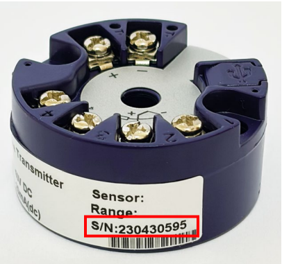
Posição da numeração serial do transmissor
